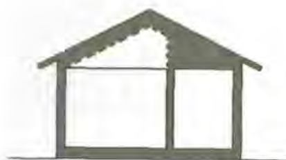
1-KERROKSIINEN TALO, RUNKOSYVYYS N. 6,5 M KATTOKALTEVUUS 1/2
