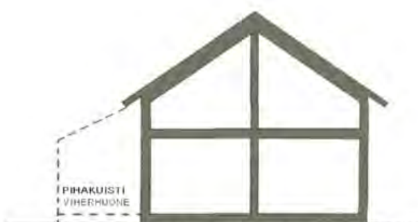
1u3/4-KERROKSIINEN TALO, RUNKOSYVYYS N. 8 M KATTOKALTEVUUS 1/1,5
