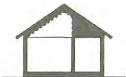
1-KERROKSIINEN TALO, RUNKOSYVYYS N. 6,5 M KATTOKALTEVUUS 1/1,5
