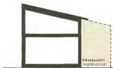
I 1 / 4 -KERROKSIINEN TALO, RUNKOSYVYYS N. 6 M KATTOKALTEVUUS 1/4
