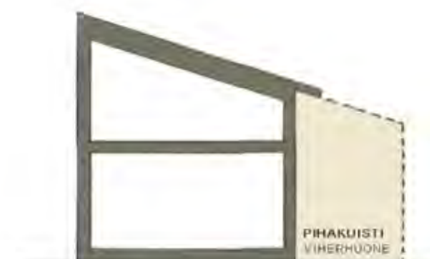
I 1 / 4 -KERROKSIINEN TALO, RUNKOSYVYYS N. 6 M KATTOKALTEVUUS 1/3
