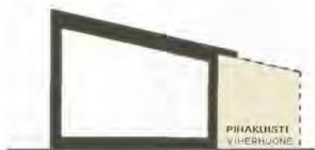
I-KERROKSIINEN TALO, RUNKOSYVYYS N. 6 M KATTOKALTEVUUS 1/4
