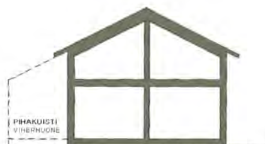
1u3/4-KERROKSIINEN TALO, RUNKOSYVYYS N. 8 M KATTOKALTEVUUS 1/2
