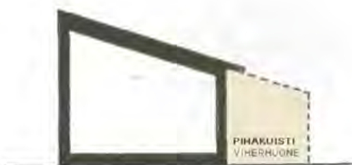
I-KERROKSIINEN TALO, RUNKOSYVYYS N. 6 M KATTOKALTEVUUS 1/3
